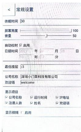
**休眠时间：**设备在休眠时间指定的时间内无操作（刷卡、触屏、人脸），将自动进入低功耗模式，降低屏幕亮度，关闭红外灯等。单位为秒，默认值为 30。
