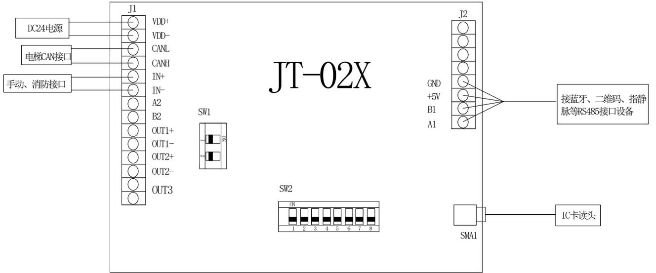
CAN 接口系统接线原理图
