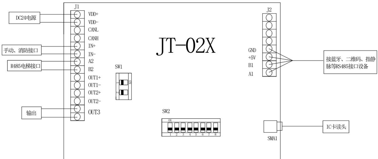
RS485 接口系统接线原理图
