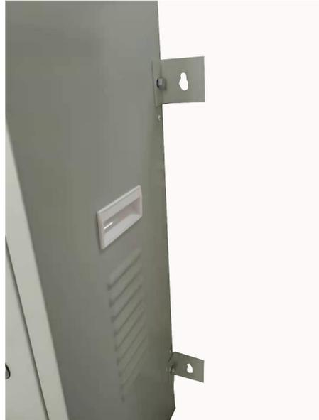
第 2 步：用 4 只 M8\*100 膨胀螺丝将在 ESS 装置固定在墙上。
